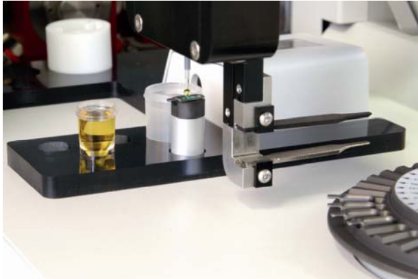
Fig. 1 : Cargador de muestras sólidas completamente automático SSA 600L con opción de líquido
