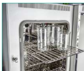
Rejillas de acero con sistema anti-vuelco para trabajar siempre de manera segura.
